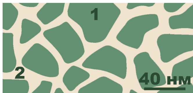
1 – кристаллиты nc (nanocrystal) – TiAlN или TiAlCN, 2 – аморфная межзёренная прослойка с кремнием Si a (amorphous) – Si или медью Cu Рисунок 4 – Схематичное изображение наноструктуры покрытий с Cu и Si
